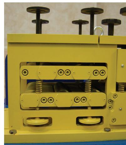
**ВНИМАНИЕ!** Зазор между верхним и нижним роликами должен быть равномерным по ширине роликов во избежание искривления полосы в горизонтальной плоскости.
