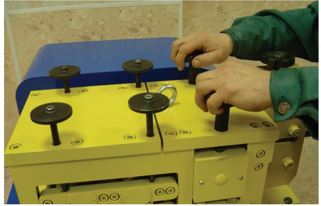
7.2.3 Ввести заготовку между роликами направляющего устройства, завернуть регулировочный винт с таким расчётом, чтобы заготовка свободно перемещалась в продольном направлении, но была зажата без люфтов в поперечном.
