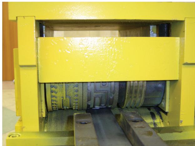
8.1.7 Вставив полосу в выходное окно кузнечного блока, выставить верхний балансир таким образом, чтобы оба его ролика касались полосы; при этом зазор между роликами верхнего и нижнего балансиров должен быть равномерным по ширине роликов.
