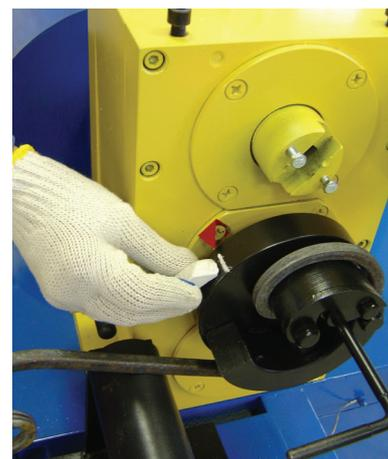
Закрепить заготовку, повернув стопор штампа «Улитка» против часовой стрелки до упора.
