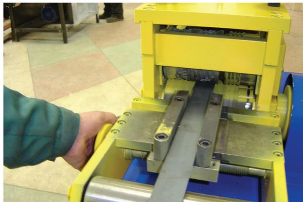
8.1.3 Проверить лёгкость перемещения полосы между планками направляющего устройства в продольном направлении. При необходимости откорректировать положение подвижной планки, повторив действия по п.8.1.2.
